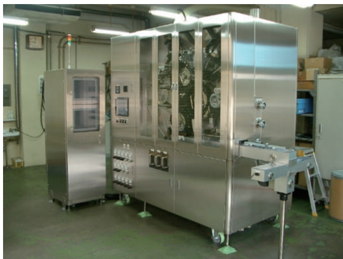
PIMW7001 (両面印刷、印刷・外観検査兼備)
