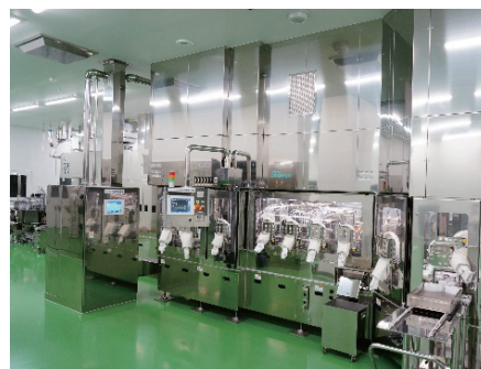
渋谷工業(株)製アンプル充填ライン
