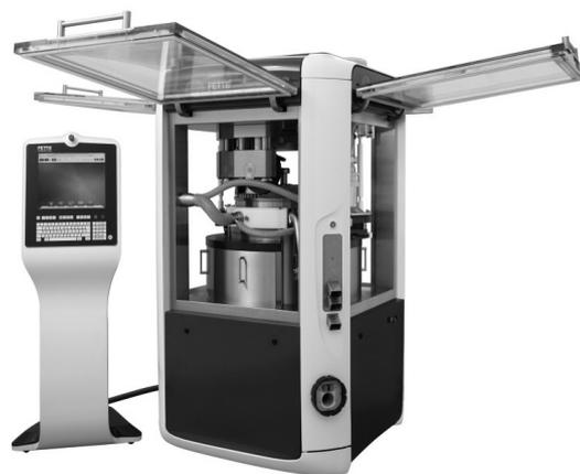
ユーザーの要求に対応した新製品のFEシリーズを日本市場へ初めて投入します。どのシリーズも独自設計のセグメント方式（臼交換不要）の採用で品換えの休止時間を大幅に短縮でき、生産品目の多いジェネリックメーカー様に変りやすい装置です。FS12タイプの杵を採用する事により、同じ装置で杵立数も増やせ、従来の40～50%生産量を増やすことが出来ます。また本機は配合剤としての2層錠や3層錠の製造に最適です。
