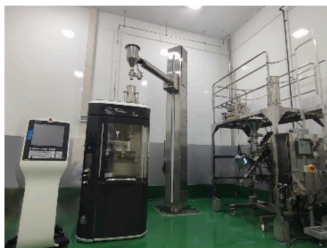
直打システム (左：打錠機FE35、右：SCTS-MG200)
