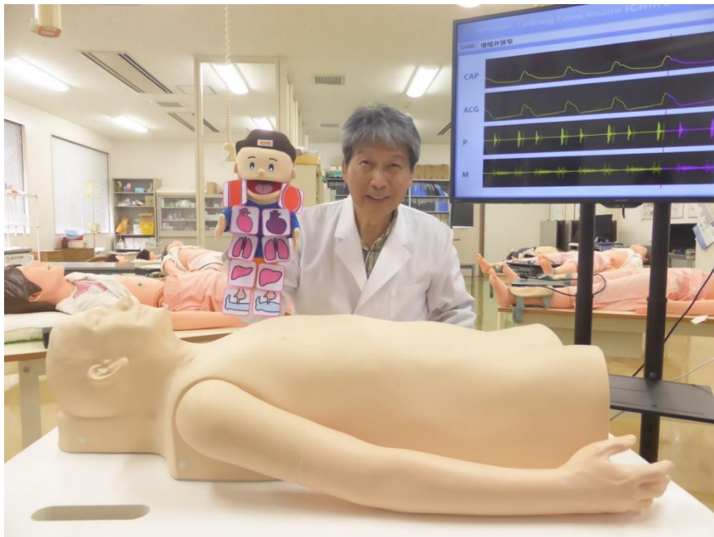
写真 3 心臓病患者シミュレータと心不全を表現した ADME 人形
