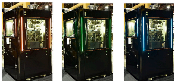
LEDランプが点灯し、遠目からでも打錠機のステータスが一目で分かるようになっています。
